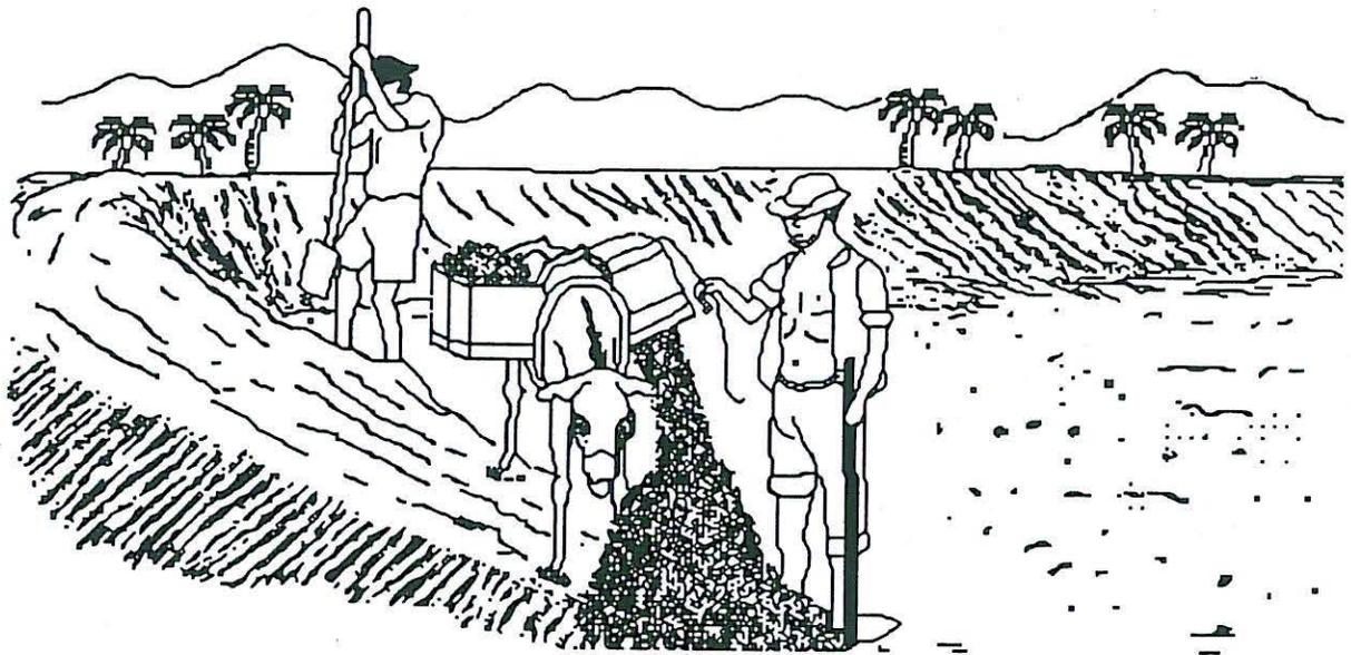
Figure 3 : Mulets ou boeufs peuvent être utilisés pour déplacer la terre des étangs. Chaque couche de 10 cm de terre ajoutée à la digue doit être compactée.
